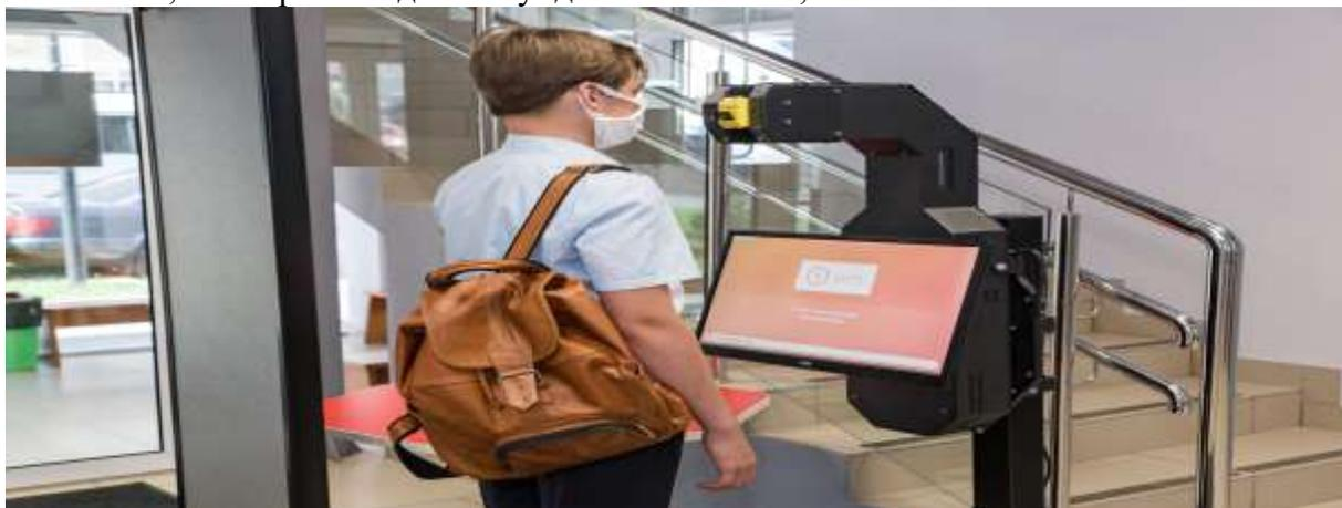
**Рис 7. Терминал для бесконтактного измерения температуры тела Promobot Thermocontrol**
