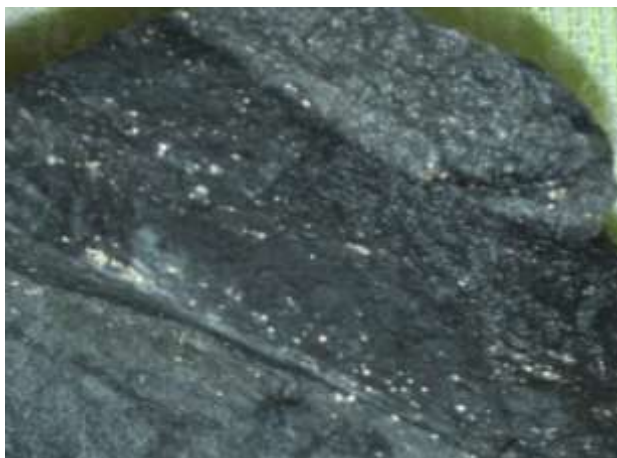
Рис.3 Прослойки, обогащенные углеродистым веществом и пиритом (Шарыкты, обр.Шк-28, скв. Шк-40, инт.193-194м).
